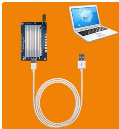
对讲模块USB配置接口连接示意图
